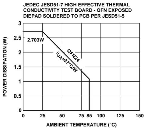
FIGURE 10. PACKAGE POWER DISSIPATION vs AMBIENT TEMPERATURE
