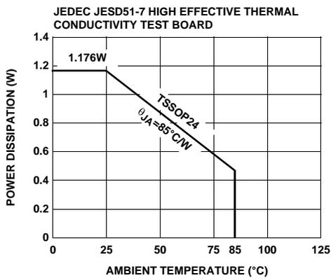
FIGURE 8. PACKAGE POWER DISSIPATION vs AMBIENT TEMPERATURE
