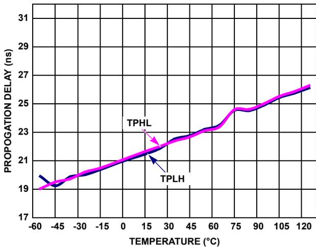
FIGURE 12. DRIVER DIFFERENTIAL PROPAGATION DELAY vs TEMPERATURE (ISL3158AE)
