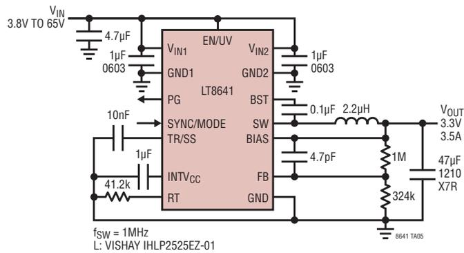
Ultralow EMI 5V, 3.5A Step-Down Converter
