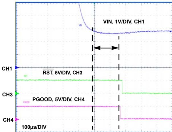
FIGURE 10. VIN FALLING TO PGOOD FALLING DELAY TIME
