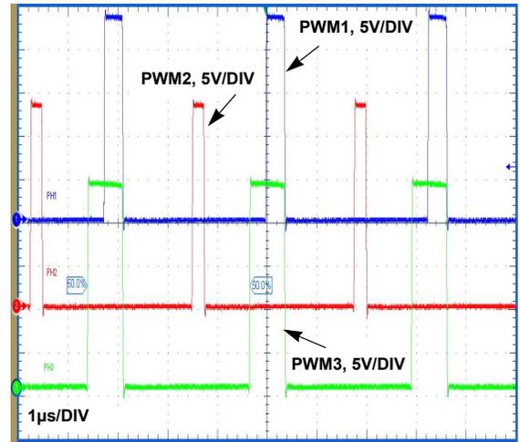
FIGURE 15. PHASE NODE PWM WAVEFORMS,  $V_{IN} = 24V$
