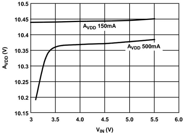
FIGURE 3. LINE REGULATION A<sub>VDD</sub> vs V<sub>IN</sub>
