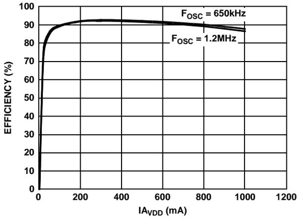
FIGURE 1. A<sub>VDD</sub> EFFICIENCY vs I<sub>A<sub>VDD</sub></sub>
