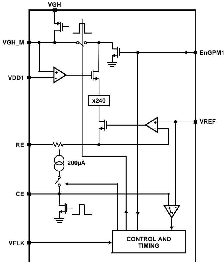
FIGURE 16. GATE PULSE MODULATOR CIRCUIT BLOCK DIAGRAM
