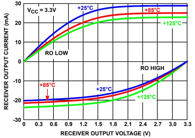
FIGURE 6. RECEIVER OUTPUT CURRENT vs RECEIVER OUTPUT VOLTAGE (V<sub>CC</sub> = 3.3V)
