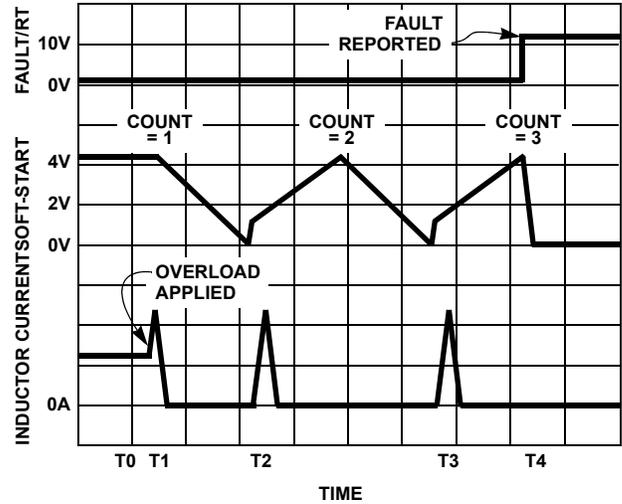
FIGURE 8. OVER-CURRENT OPERATION
