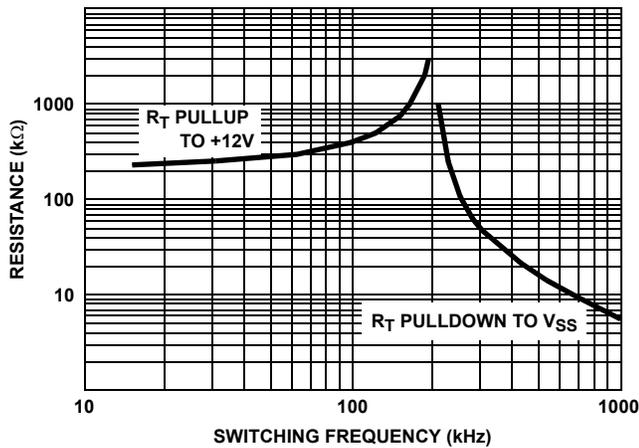
FIGURE 4. R<sub>T</sub> RESISTANCE vs FREQUENCY
