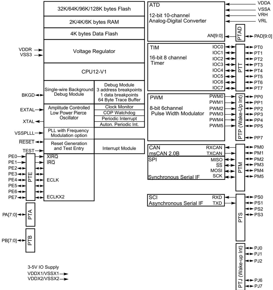
Figure 1-1. MC9S12P-Family Block Diagram
