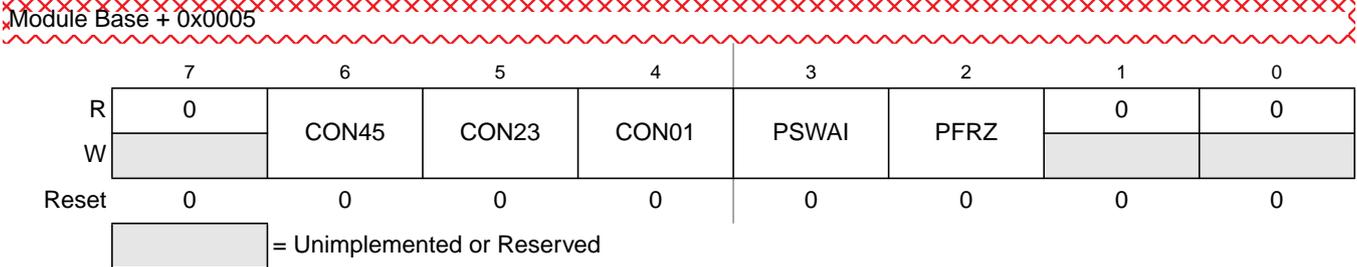
**Figure 10-8. PWM Control Register (PWMCTL)**
