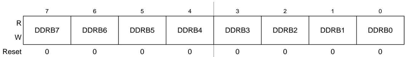
Figure 2-4. Port B Data Direction Register (DDRB)
