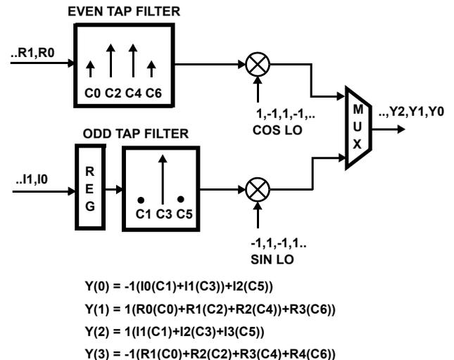
FIGURE 20. POLYPHASE IMPLEMENTATION OF QUADRATURE TO REAL CONVERTER
