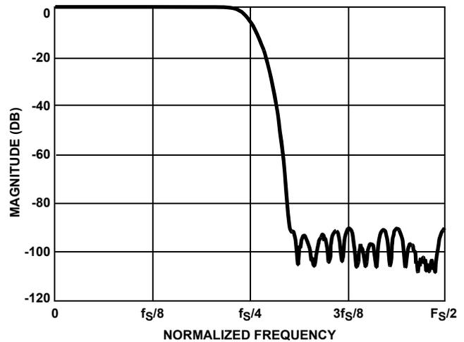
FIGURE 2. FREQUENCY RESPONSE OF 67-TAP HALFBAND FILTER
